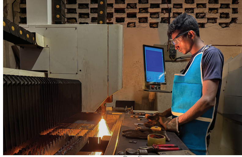
CNC (Computer Numerical Control) লেজার কাটিং মেশিনের সাহায্যে নিখুঁতভাবে কাটা হচ্ছে ধাতব পাত
